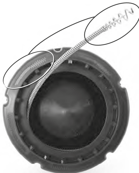
Figura 20 – Ao carregar o cabo para dentro do tambor interior, enrole-o rodando PARA A DIREITA
