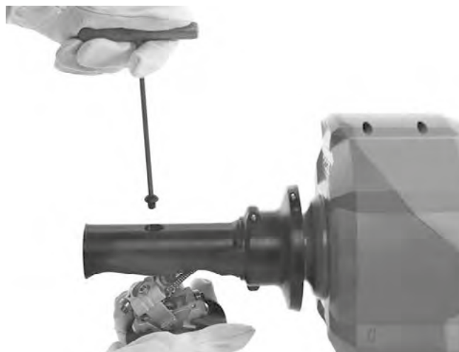
Figura 16A – Remoção do mecanismo AUTOFEED
